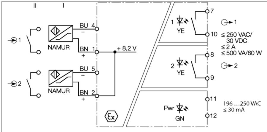
Der 2-kanalige Trennschaltverstärker vom Typ IM12-22EX-R ist mit eigensicheren Eingangskreislängen ausgestattet.
