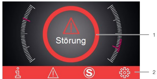
Abb. 25: Bildschirm bei Auftreten einer Störung
