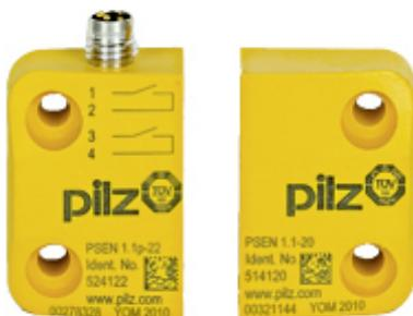
Magnetischer Sicherheitsschalter 2 n/o, 4-pol. M8 Stiftstecker, rechteckige Bauform, Höhe Bauform 13 mm, IP67, Schaltabstand 8 mm, für Anwendungen mit PSEN ix1, VP = 1 Stück mit Betätigern.
