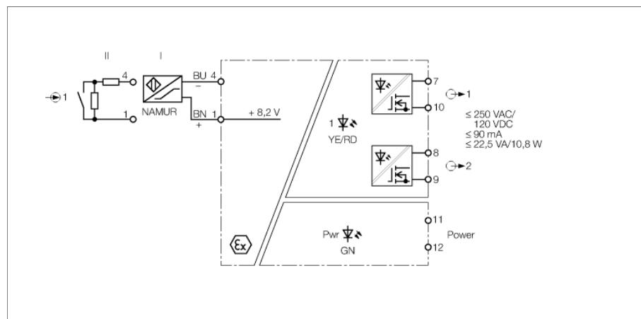
Der 1-kanalige Trennschaltverstärker vom Typ IM1-12EX-MT ist mit einem eigensicheren Eingangskreis ausgestattet.
