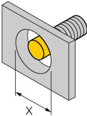
Bei allen nichtbündigen *uprox®+* Gewinderohrschaltern ist ein Einbau bis zur Rohrkante erlaubt. Ein sicherer Betrieb ist hierbei mit einer maximalen Reduzierung des Schaltabstandes von 20% gewährleistet.
