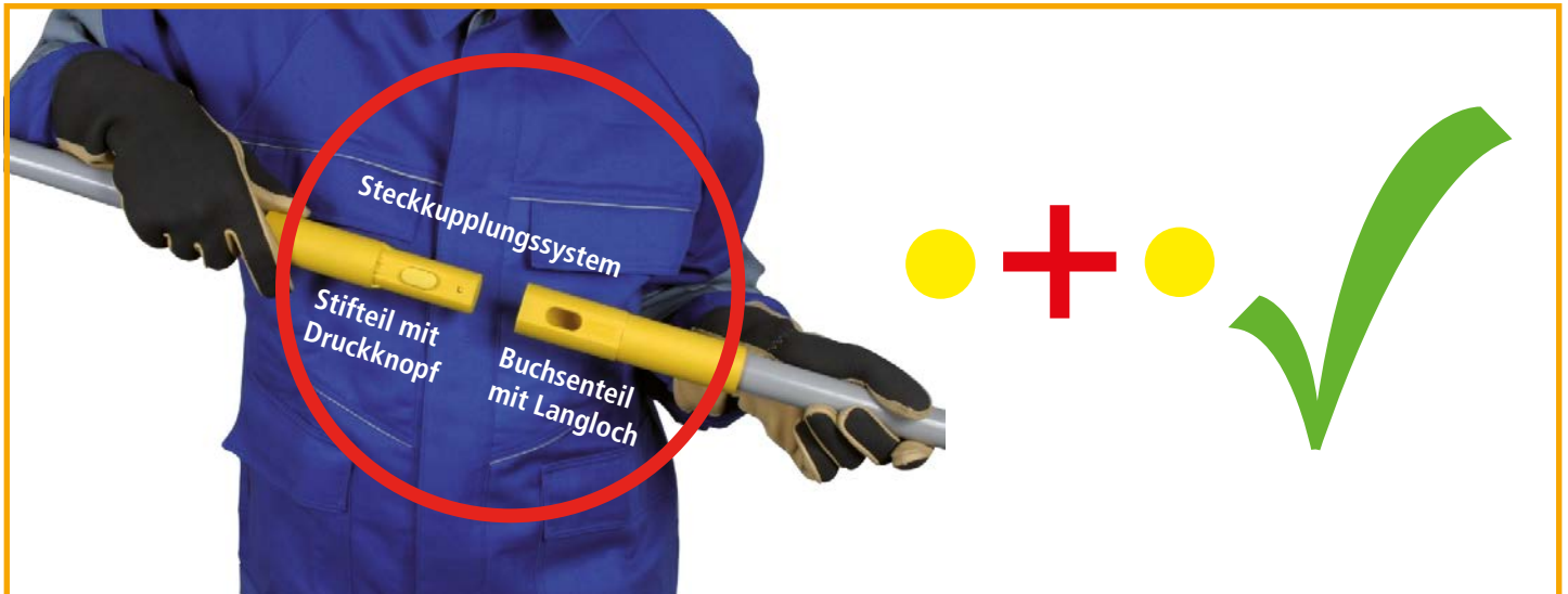
Bild 9 Einzelteile in der Kombination "GELB" und "GELB"
