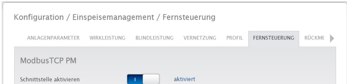
Abb.: Modbus TCP PM mit aktivierter Schnittstelle
