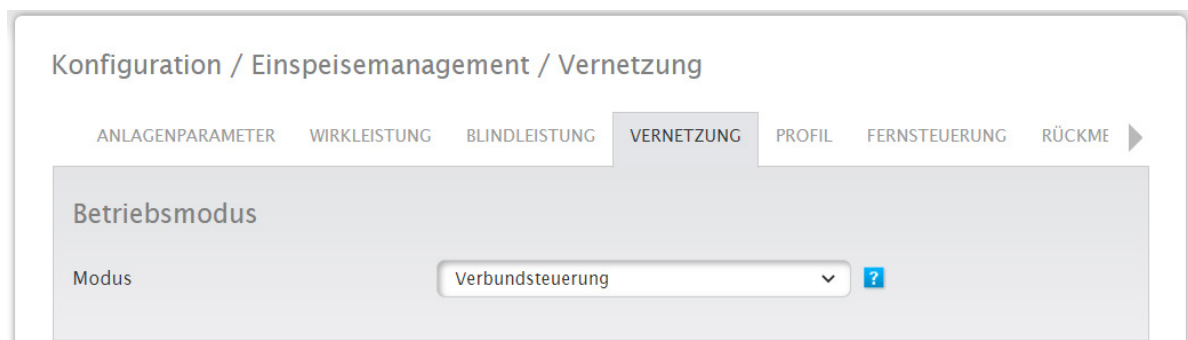
Abb.: Aktivierte Verbundsteuerung
