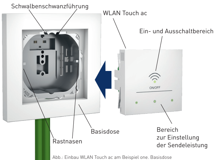
Abb.: Einbau WLAN Touch ac am Beispiel one. Basisdose
