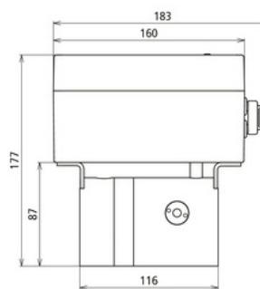
Löscherät für den direkten Anschluss an die Erfassungsgeräte DSRT DD CPS und DSRT DD PS.
