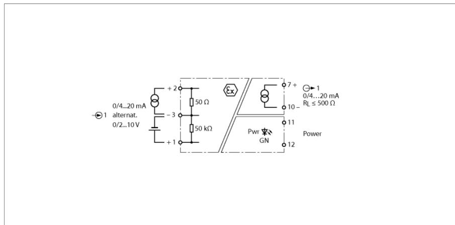
Über den 1-kanaligen Analogsignaltrenner IM31-11EX-I werden normierte, aktive Spannungs- oder Stromsignale galvanisch getrennt aus dem Ex-Bereich in den Nicht-Ex-Bereich übertragen.
