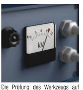
Durchschlagsfestigkeit bei 10.000 Volt gibt dem Anwender die beruhigende Gewissheit, dass sein Schraubendreher auf seine wichtigste Eigenschaft, Isolation, geprüft worden ist. Wera VDE-Schraubendreher werden
