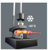
Auch bei extremen Einsatzbedingungen ist durch die geprüfte Kaltschlagfestigkeit bei -40°C die Sicherheit gewährleistet.
