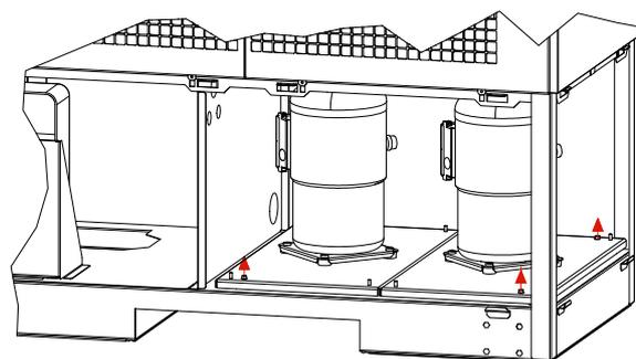
Rimozione/avvitamento della sicura per il trasporto (4x)
