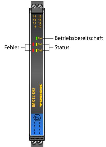
Der 2-kanalige Ventil-Steuerbaustein vom Typ IMX12-DO01-2U-2U-0/24VDC stellt ein in Strom und Spannung begrenztes, eigensicheres Ausgangssignal bereit. Somit können Verbraucher im explosionsgefährdeten Bereich direkt angesprochen werden. Typische Anwendungen sind das Ansteuern von Ex i-Pilotventilen, das Versorgen von Anzeigen und die Versorgung von Transmittern.
