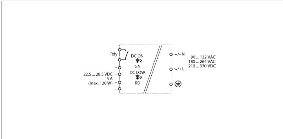
Die Stromversorgung des Typs IM82-24-5,0 dient zur Versorgung von Gleichspannungsverbrauchern, insbesondere von Schalt- und Überwachungsgeräten der TURCK-Baureihen IM, IME, IMS und IMC.
