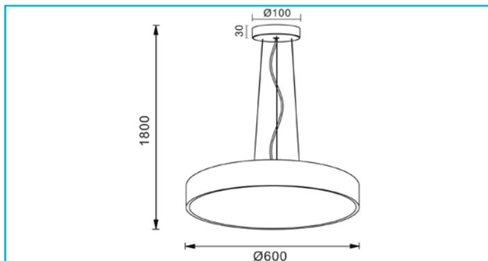
Die Pendelleuchten der MENKAR - Serie überzeugen mit cleveren Beleuchtungsfunktionen und hochwertigem Aluminium-Akzenten. Das separat schaltbare Rücklicht (ca. 15 - 20 % indirekter Lichtanteil) ermöglicht eine dauerhafte indirekte Beleuchtung, während das Hauptlicht jederzeit zugeschaltet werden kann.
