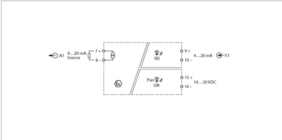
Über den 1-kanaligen Signaltrenner IMX12-AO01-1I-1I-H0/24VDC wird das normierte Stromsignal 1:1 galvanisch getrennt aus dem Nicht-Ex-Bereich in den Ex-Bereich übertragen. Neben dem Analogsignal können bidirektional auch digitale Signale der HART®-Kommunikation übertragen werden. Typische Anwendungen sind die Ansteuerung von I/P-Wandlern oder Anzeigegegeräten im Ex-Bereich.
