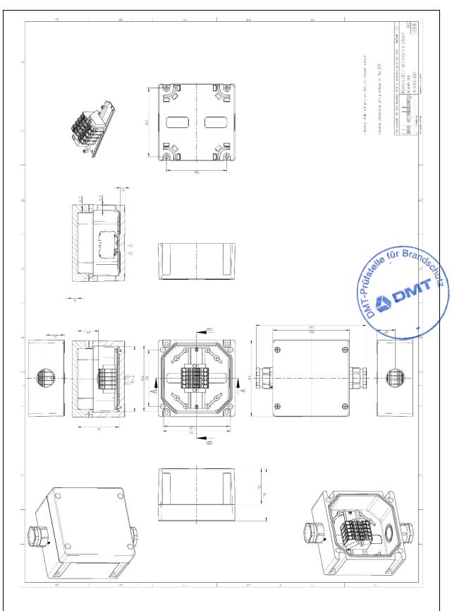
Kabelanlage mit integriertem Funktionserhalt: Abzweigdosen "WKE 200", "WKE 300" und "WKE 400" der Günther Spelsberg GmbH + Co. KG zur Verwendung in Kabelanlagen mit integriertem Funktionserhalt
