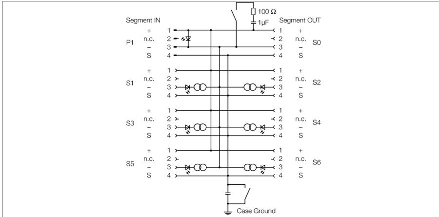
Der sechskanalige Verteilerbaustein vom Typ JBBS-48SC-E613/3G ist für den PROFIBUS-PA ausgelegt.
