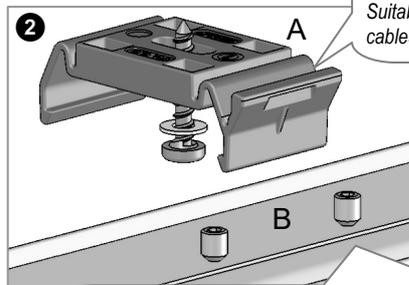
Zur Durchführung von Kabeln bis 0.75 mm<sup>2</sup> geeignet.
