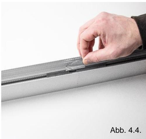
Zum Abschluss die Lichtdichtigkeitsfolie von innen auf die Profilhaft der beiden Leuchtenprofile kleben.
