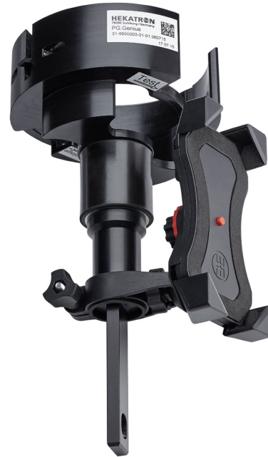
Abb. 1: Prüfgerät Genius mit Smartphone-Halterung (Abbildung ähnlich)
