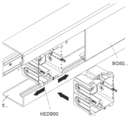
Jm einen optimalen Sitz der Geräteeinbaudose iB80 zu gewährleisten, müssen die angrenzenden Kanäle (BO...) über den abgesenkten Dosenrand gehoben werden.
