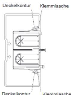
**4.** Geräteeinsatz verdrahten und mittels Befestigungsschrauben (B) anschrauben. Die Montage der Steckdosen darf nur durch einen autorisierten Elektrofachmann erfolgen.
