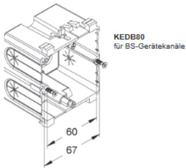
Die Geräteeinbaudose KEDB80 in die Deckelaufnahmekontur des Kanalunterteils einsetzen und ausrichten.
