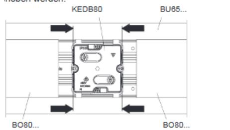
achträglichen Verschieben bei bereits eingebautem(n) Kanal müssen die Befestigungsschrauben durch die Nieten im Tragring gelöst und nach dem Verschieben wieder festgezogen werden.
