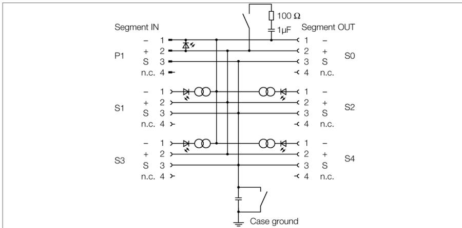
Der vierkanalige Ex-Verteilerbaustein vom Typ JBBS-49SC-M413/EX ist für den FOUNDATION™ fieldbus ausgelegt.
