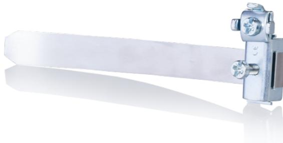
EBS4; 1/8 - 4" für Anschluss 2,5-16 mm<sup>2</sup>, montiert; Material: Spannband Edelstahl 1.4301, Klemmkörper Stahl
