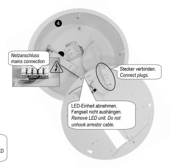
Beim Einlegen der LED-Einheit darauf achten, dass Innenseite von Gehäuse nicht zerkratzt wird und keine Kabel gequetscht werden. When installing the LED unit make sure that the inner side of the housing is not scratched and cables are not pinched.
