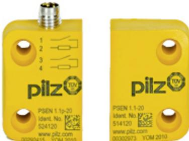
Magnetischer Sicherheitsschalter 2 n/o, 4-pol. M8 Stiftstecker, rechteckige Bauform, Höhe Bauform 13 mm, IP67, Schaltabstand 8 mm, VP = 1 Stück mit Betätigter.
