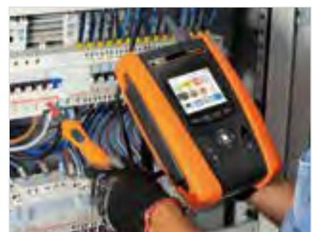
GSC60 mit externer Prüfsonde PR400
