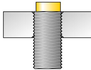
Bei allen nichtbündigen uprox<sup>+</sup> Gewinderohrschaltern ist ein Einbau bis zur Rohrkante erlaubt. Ein sicherer Betrieb ist hierbei mit einer maximalen Reduzierung des Schaltabstandes von 20% gewährleistet.
