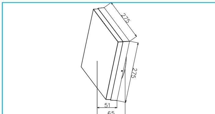
Die Hausnummernleuchte CASA bietet Platz für bis zu 4 Ziffern und/oder Buchstaben mit einer Höhe von jeweils 10 cm, so dass die Hausnummern gut lesbar sind. Durch einen einstellbaren Dämmerungsschalter passt sich die Wandleuchte automatisch der Umgebungshelligkeit an. Zusätzlich kann die Lichtfarbe in 2 Stufen (3.000 / 4.000 K) eingestellt werden.
