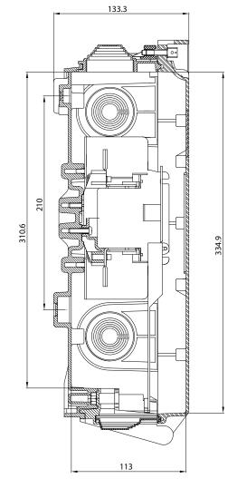
Hausanschlußkasten KH00 Typ 1x3xNH00 House termination box KH00
