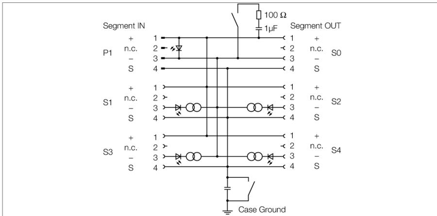
Der vierkanalige Ex-Verteilerbaustein vom Typ JBBS-48SC-E413/EX ist für den PROFIBUS-PA ausgelegt.
