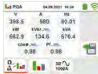
Leistungsanalyse Wirk-, Blind- & Scheinleistung
