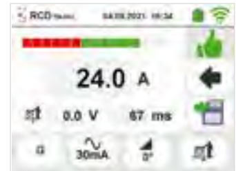
RCD Messung Ergebnis Auslösezeit t_a – Strom I_a und U_a
