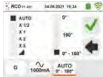
RCD Messung Auswahl der Messmethode
