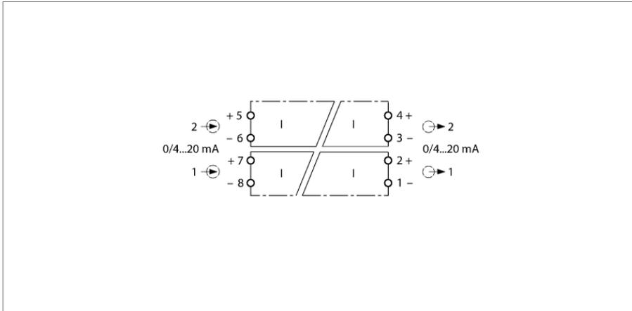
Über den 2-kanaligen Analogsignaltrenner des Typs IMS-AI-DLI-22-DLI/L werden normierte, aktive Stromsignale galvanisch getrennt übertragen.
