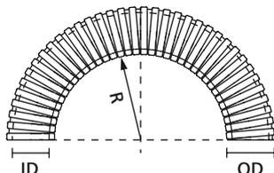
HelaGuard Metallschlauch mit Kunststoffmantel
