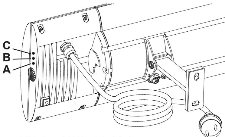
Driftsindikator: På D2 Lysdioder A, B, C
