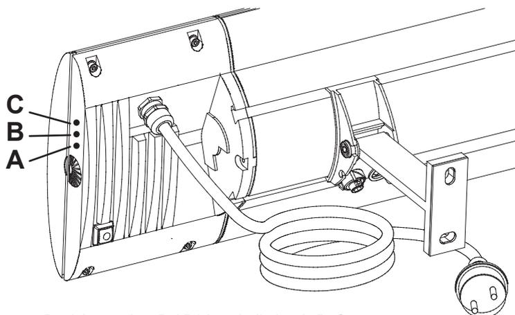
Betriebsanzeige: Bei D2 Leuchtdioden A, B, C
