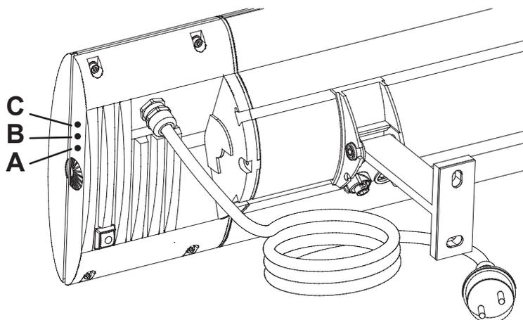
Affichage de fonctionnement: Sur D2 diodes électroluminescentes A, B, C
