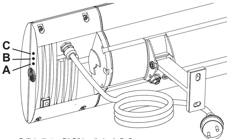
Driftsindikator: På D2 Lysdioder A, B, C
