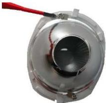
2) Lösen Sie beide Schrauben und drehen Sie die Fixierteile nach außen.
