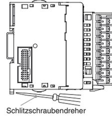
Bringen Sie an beiden Seiten des EJ1C-EDU jeweils eine Abschlussplatte an (Abschlussplatten PFP-M liegen dem End Unit bei).
