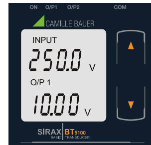
Anzeige 3: Spannungs- Eingang und Ausgang 1 als Spannung
