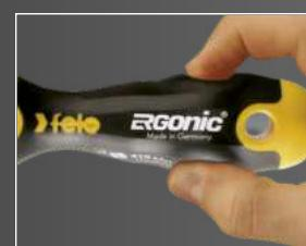
Unser ERGONIC® K kombiniert eine Ratsche, einen Knick-Schraubendreher und ERGONIC®-GRIFF in einem Werkzeug. Der Knickmechanismus ermöglicht das Erreichen besonders schwer zugänglicher Schrauben und bietet mit bis zu 50 Nm ein sehr hohes Drehmoment. Dabei kann ohne Umstecken in einen der vier Knickwinkel gewechselt werden. Dank der Ratsche ist das Verschrauben sehr effizient möglich.
