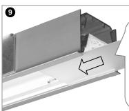
STRL-LK060-Z 690... Lichtlenkungsfolien von Rolle einziehen. Montageanweisung 830871 für Lichtlenkungsfolien (nanoOptix) beachten!
