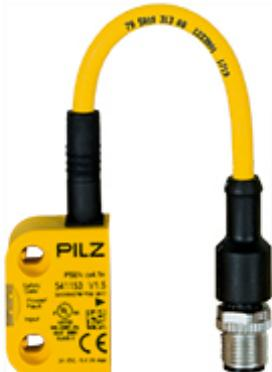
RFID Sicherheitsschalter 2 sichere HL-Ausgänge, 8-pol. M12 Stiftstecker, mit 0,15 m Kabel, eine Betätigungsrichtung, Unterstützung für SDD, IP67, Schaltabstand abhängig vom Betätiger, reihenschaltbar, VP = 1 Stück codierter Schalter ohne Betätiger.
