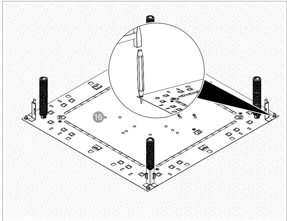
**Abb. 16:** Unterteil befestigen
