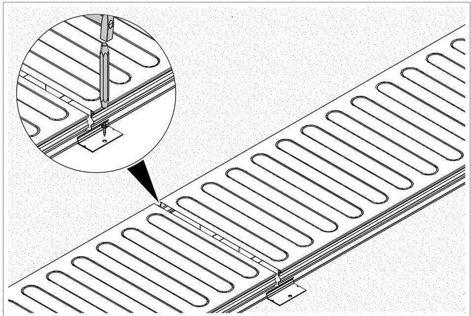
**Abb. 23:** Verbindungslasche befestigen
