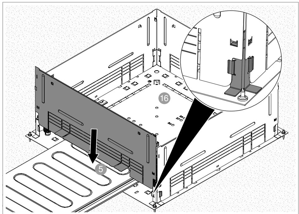
**Abb. 38:** Höhenerweiterung montieren
