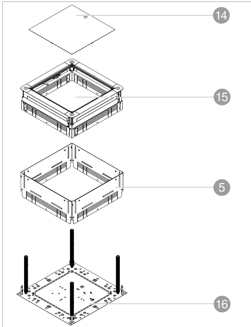
**Abb. 4:** Systemkomponenten - Unterflurdose
