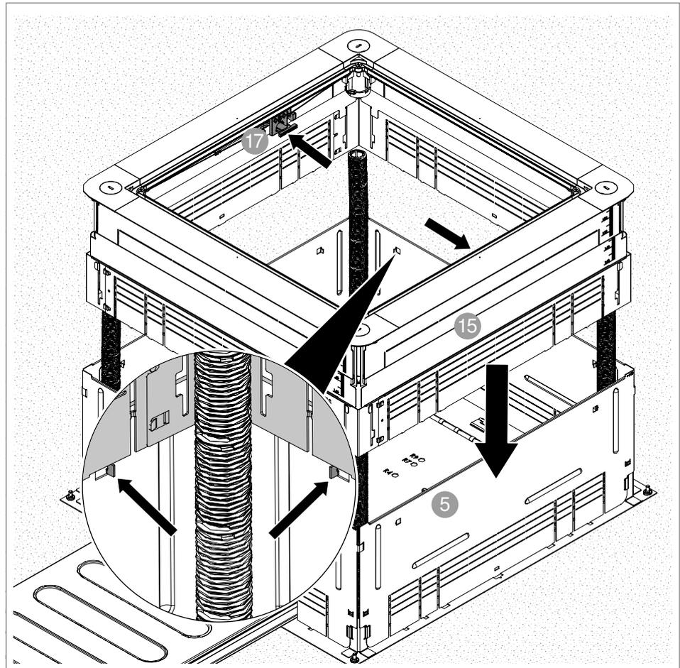
**Abb. 43:** Unterflurdose aufsetzen
