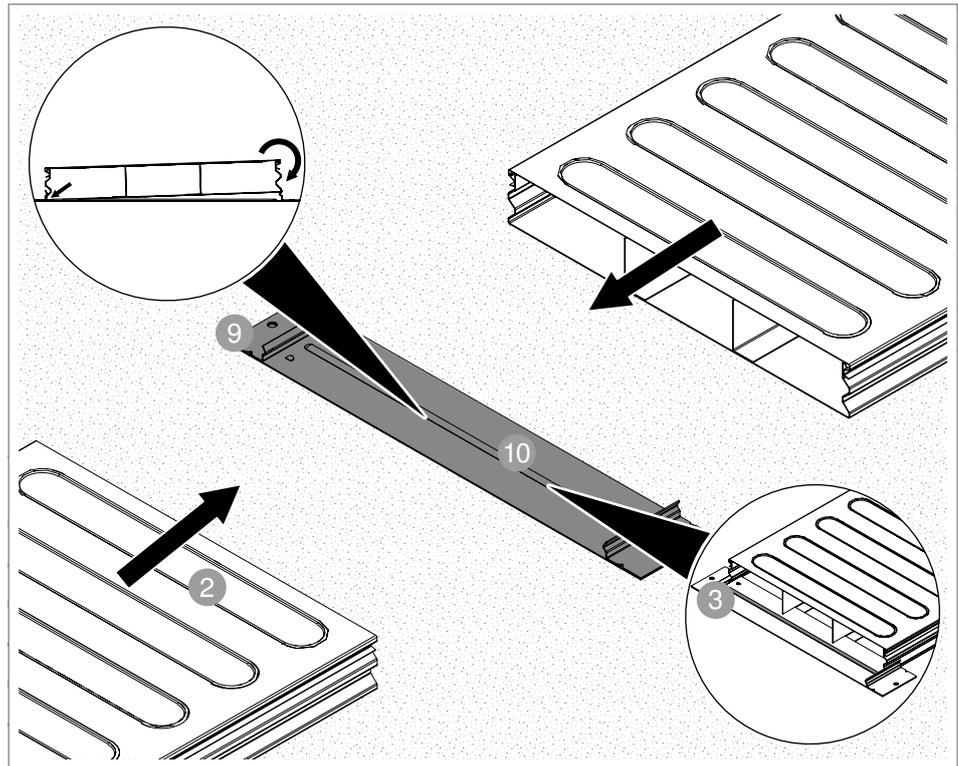
**Abb. 21:** Kanal in Verbindungslasche einrasten
