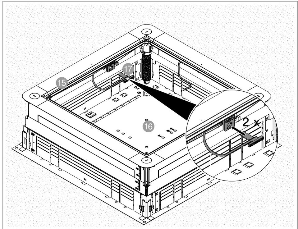
**Abb. 14:** Unterflurdose lösen
