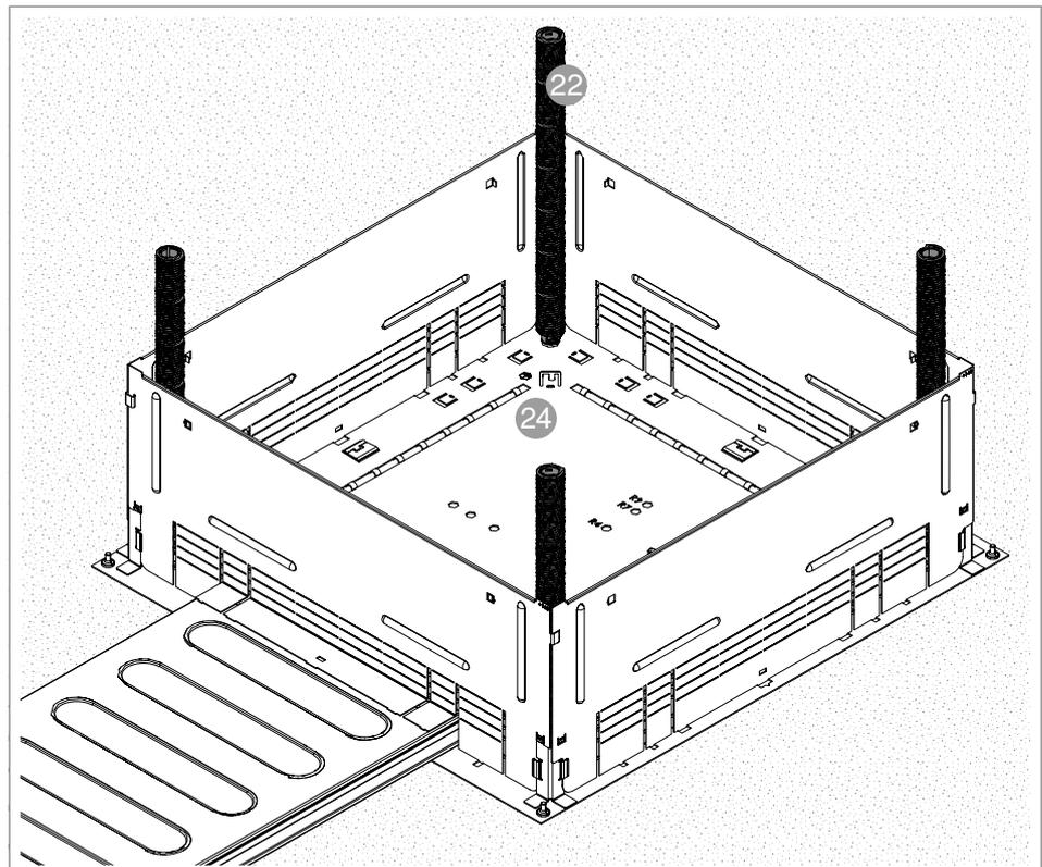
**Abb. 40:** Gewindestangen montieren
