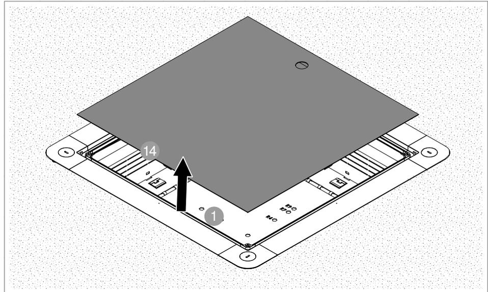
Abb. 48: Montagedeckel entfernen
