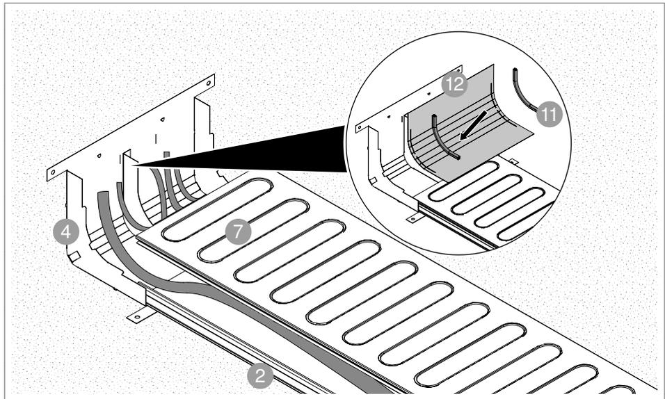
**Abb. 25:** Vertikalkrümmen verschließen
