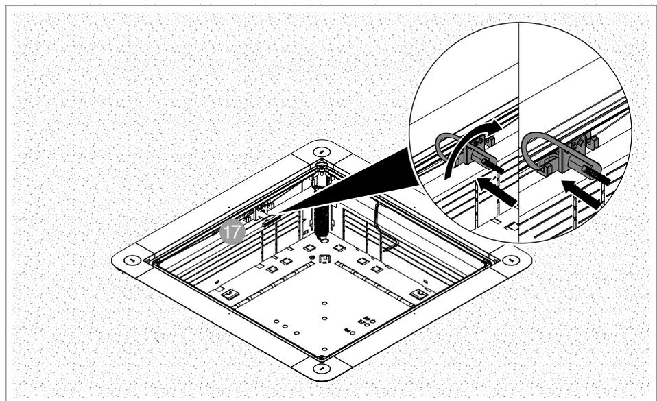
Abb. 49: Unterflurdose entkoppeln
