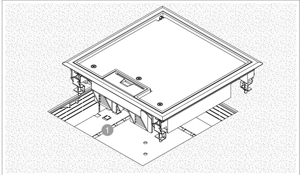
**Abb. 54:** Geräteinsätze montieren
