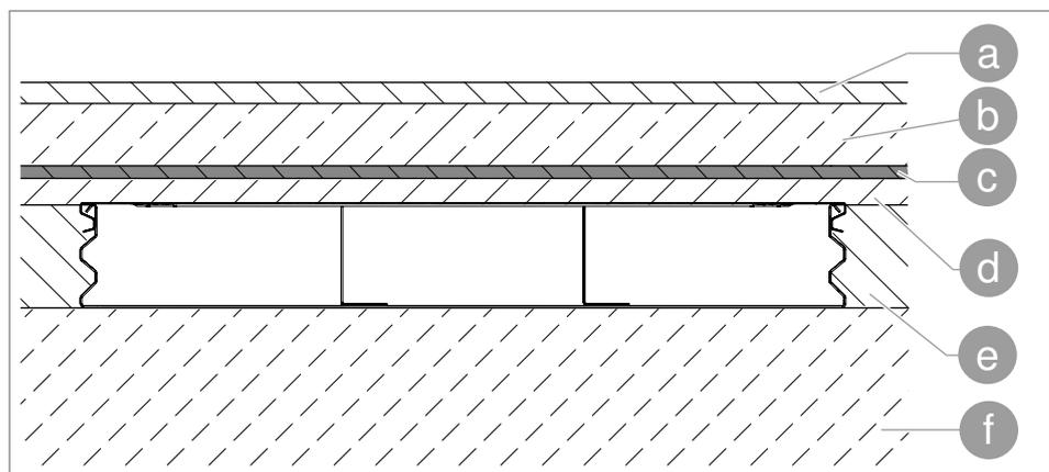
**Abb. 8:** Einbauprinzip estrichüberdecktes Kanalsystem - Kanal
