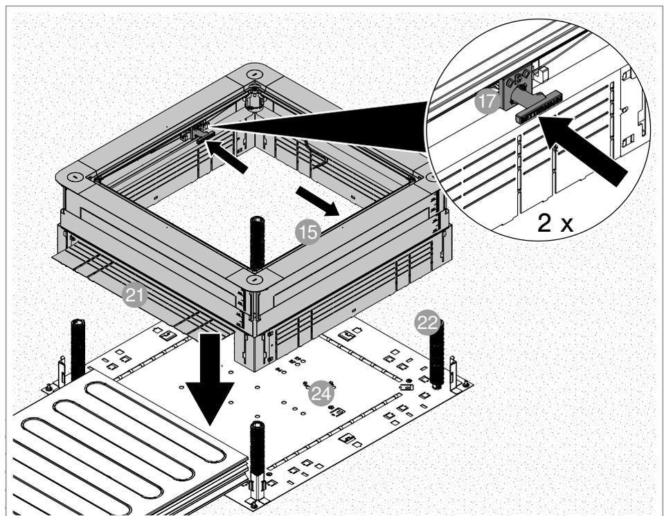
**Abb. 32:** Schnellnivellierung
