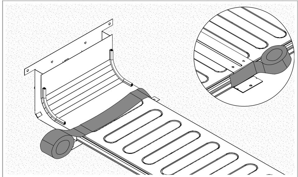
Abb. 27: Bauteilöffnungen abkleben
