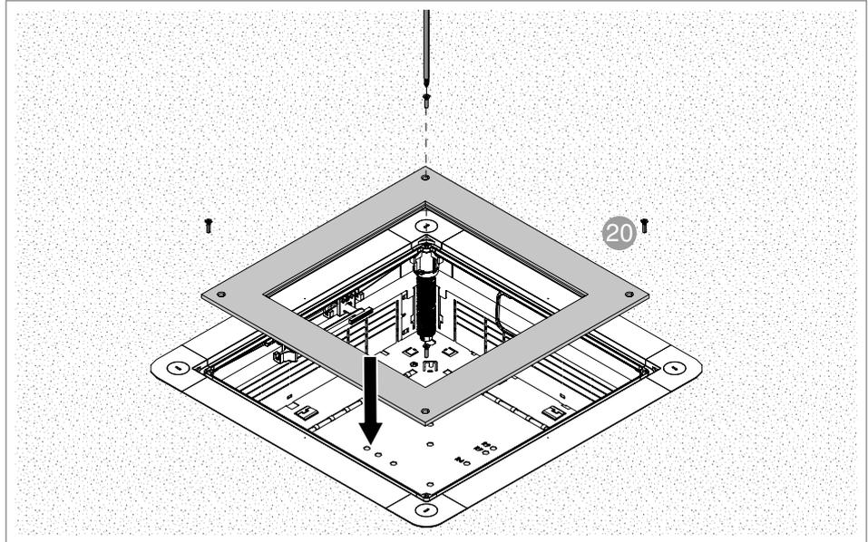
Abb. 52: Montagedeckel montieren
