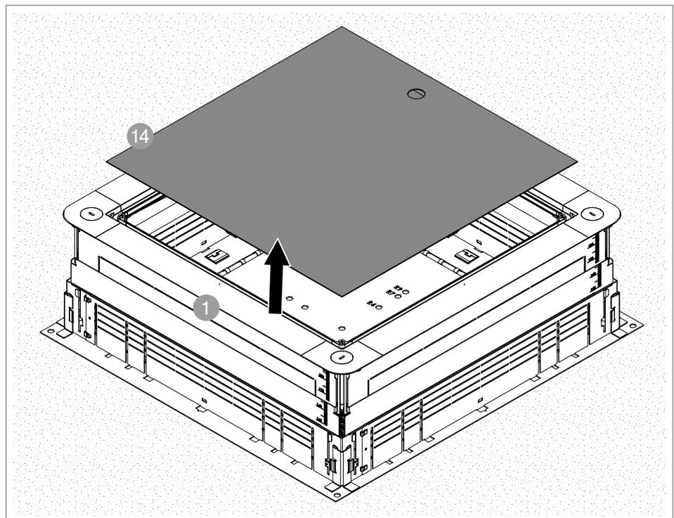
**Abb. 13:** Montagedeckel entfernen
