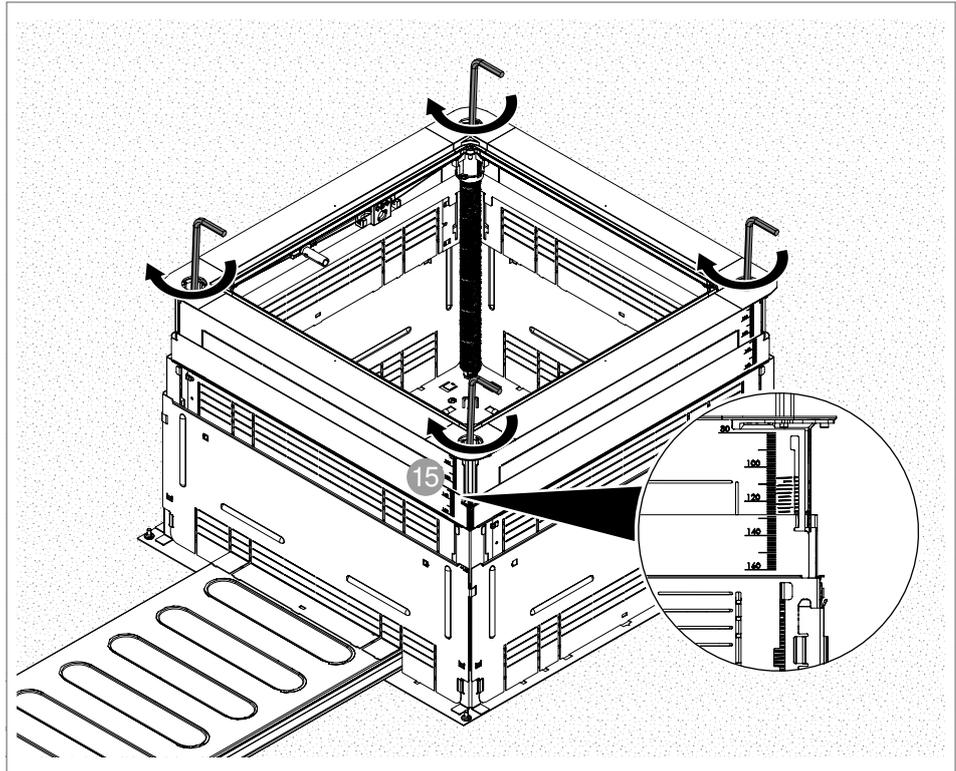
Abb. 44: Höherweiterung nivellieren
