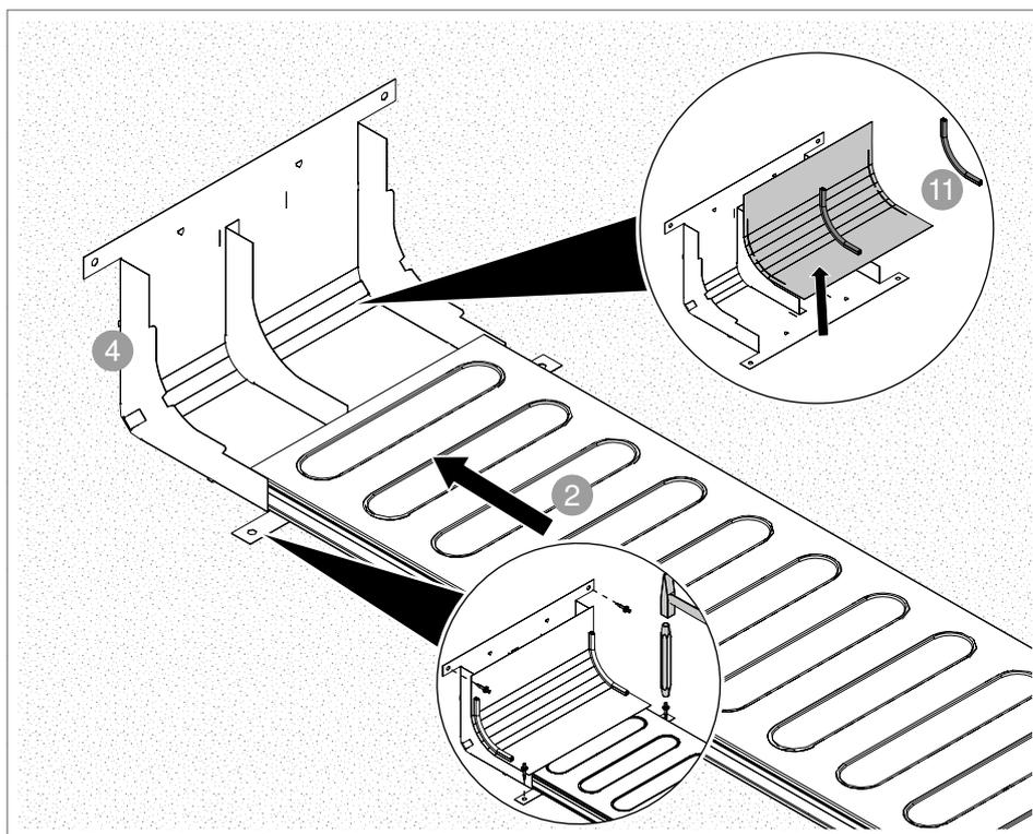
**Abb. 22:** Vertikalkrümmen öffnen
