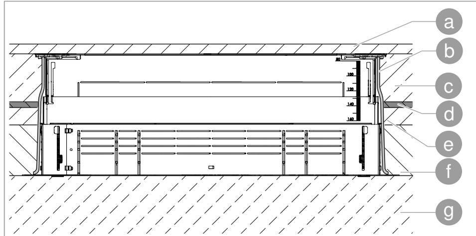
**Abb. 7:** Einbauprinzip estrichüberdecktes Kanalsystem - Unterflurdose
