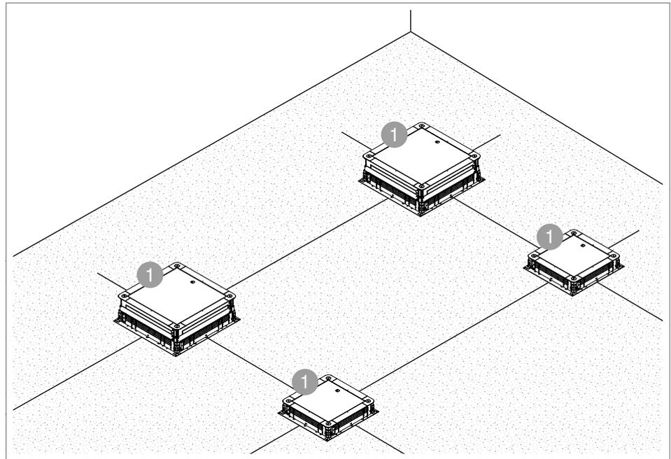
**Abb. 12:** Unterflurdose ausrichten
