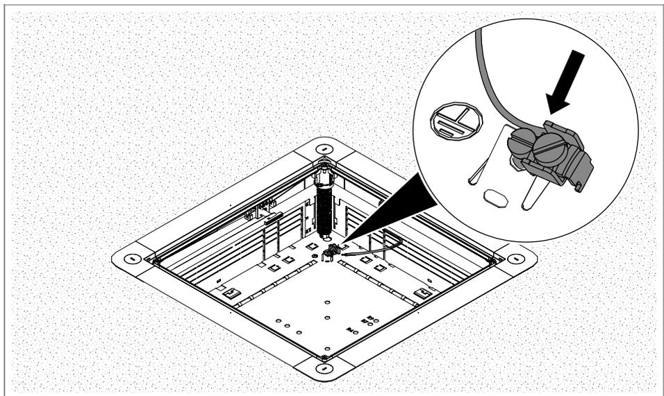
Abb. 51: Erdungsanschluss herstellen
