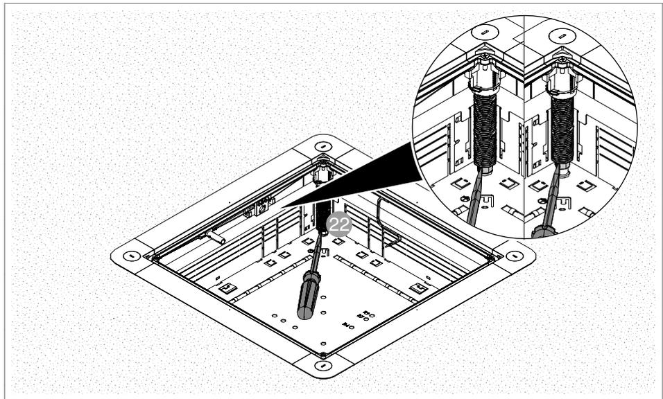
Abb. 50: Gewindestangen lösen
