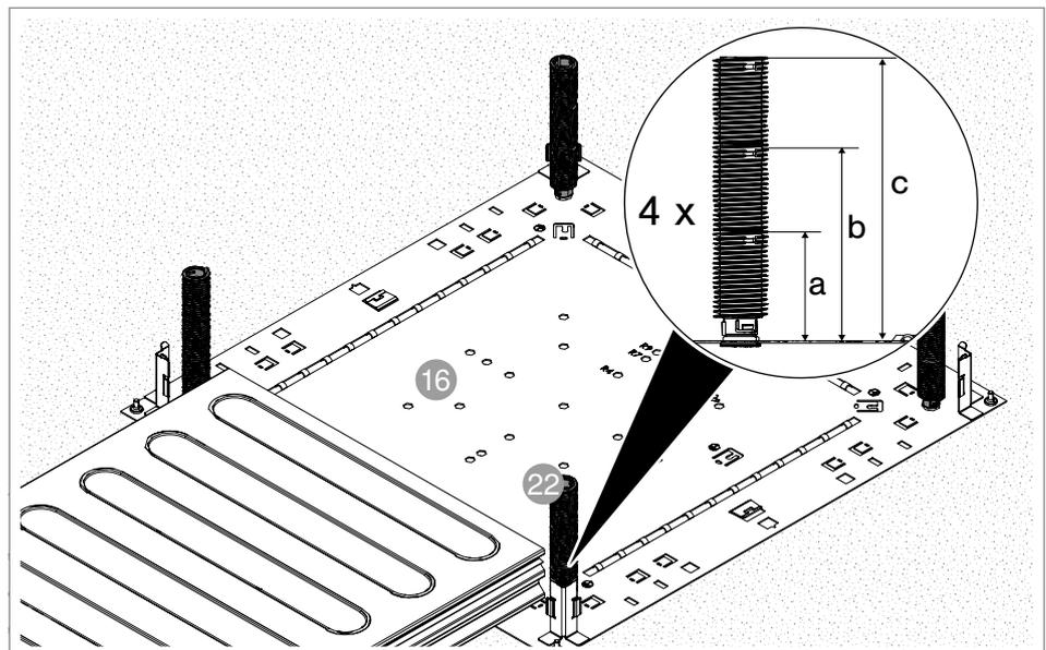
Abb. 28: Gewindestangen montieren
