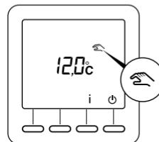
Sollte bei einer externen Programmunterbrechung das Symbol nicht angezeigt werden, können Sie die Display-Anzeige aktualisieren indem Sie die Taste i drücken, oder den Wahlschalter drehen.
