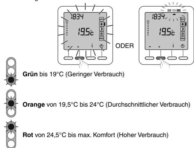
Aktivieren Sie die Funktion Displaybeleuchtung (CF05), um diese Funktion je nach Thermostatsmodell zu nutzen.
