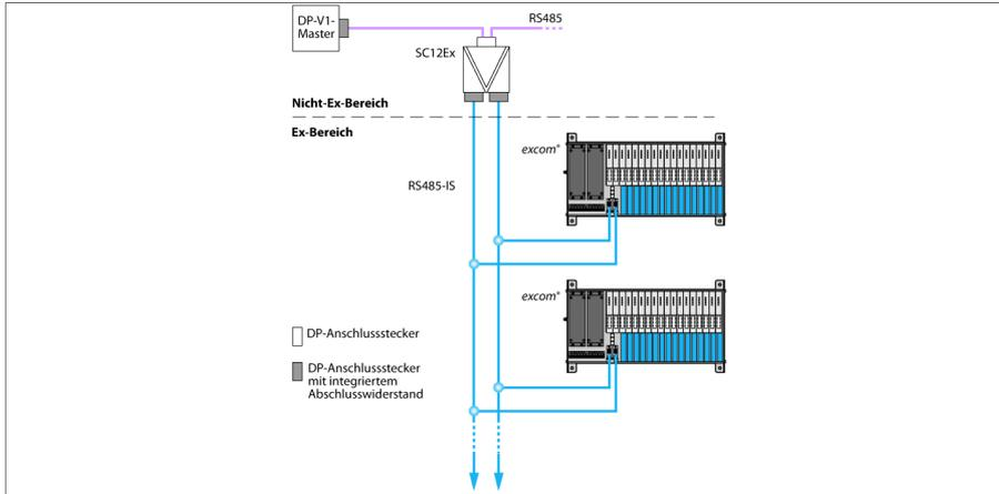
Der PROFIBUS-DP-Segmentkoppler SC12Ex von TURCK ist für die eigensichere PROFIBUS-Anschaltung entwickelt worden.
