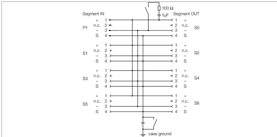
Der sechskanalige Ex-Verteilerbaustein vom Typ JBBS-48-E613/EX ist für den PROFIBUS-PA ausgelegt.
