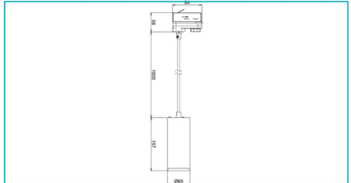
Die passenden Pendelleuchten der LUCEA-Serie für das 3-Phasen 230 V Stromschienensystem sind in den Versionen 10, 15, 20 W erhältlich und bieten bis zu 2.000 Lumen Lichtleistung. Die maximale Abhängung beträgt 1.800 mm. Über optionale Linsen lassen sich die einzelnen Modelle in ihrem Abstrahlwinkel verengen oder erweitern. Das Gehäuse der Lucea-Leuchten besteht aus Aluminium-Druckguss
