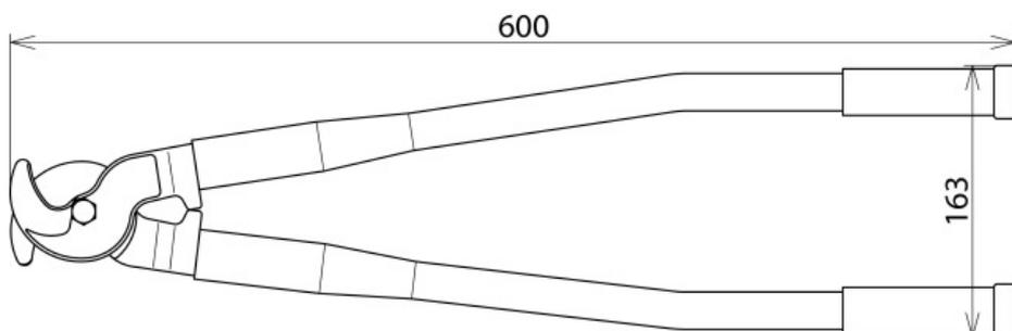
Kabelschere zum einfachen Ablängen der HVI light Leitung, HVI Leitung (Außendurchmesser 20 / 23 mm) und HVI power Leitung (Außendurchmesser 27 mm) sowie für die CUI Leitung.
