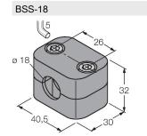
Befestigungsschelle für Glatt -und Gewinderohrsensoren; Werkstoff: Polypropylen
