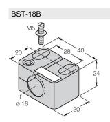
Befestigungsschelle für Gewinderohrsensoren, mit Festanschlag; Werkstoff: PA6
