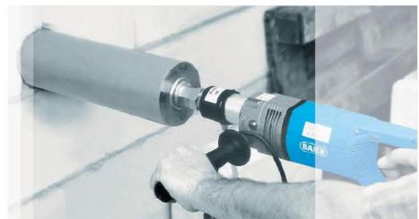
Diamant-Trockenbohrmaschine für **maßgenaues Bohren in Stahlbeton** ohne Ausbrüche von **Ø 42 mm bis 200 mm**
