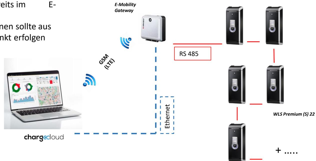
> Datenübertragung vom E-Mobility Gateway zum SW-Backend via Ethernet (LAN-Verbindung oder GSM / LTE (SIM-Karte) möglich)
